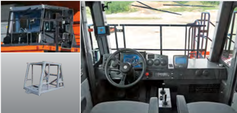
Примечание: на этой фотографии присутствует закрепленный на левой стойке монитор системы видеонаблюдения SkyAngle, устанавливаемой по требованию заказчика.
