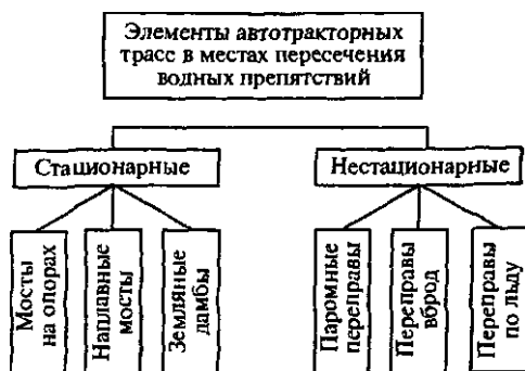
Рис. 25.11. Структурная схема средств и способов преодоления водных препятствий (водотоков)
