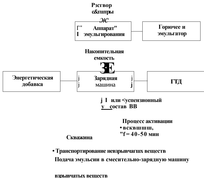
Рис. 2.47. Технологическая схема приготовления эмульсионных ВВ типа порэмитов; ГТД — газогенерирующая добавка
