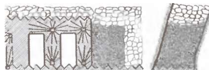
Рис. 4.34. Массовое обрмппне руды и нмешающих пород
