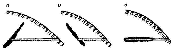
Рис. 7.66. Схемы вскрытия штольнями
