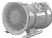
Рис. 5.9. Вентилятор ВМЭВО-8А местного проветривания
