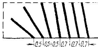
Рис. III.62. Расположение шпуров при отбойке угля зарядами БВ-48 в нйшах комбайновых лав
