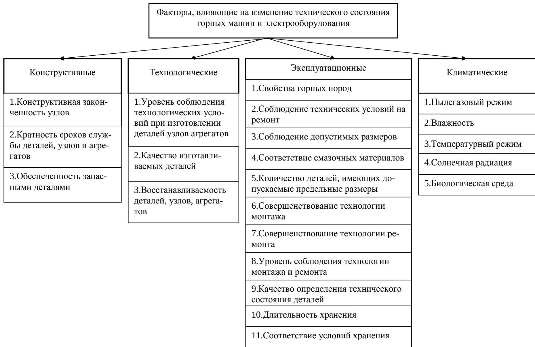
Рис. 1.2. Факторы, влияющие на техническое состояние ГМиО
