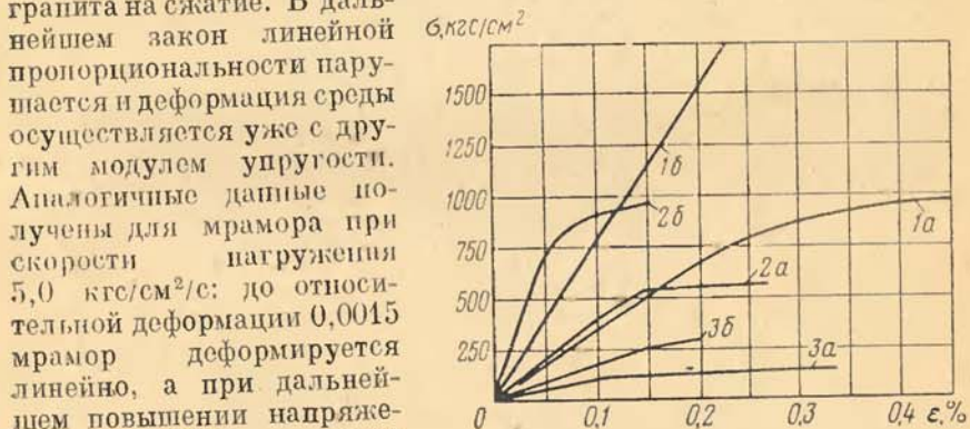
Рис. 8. Диаграмма деформации горных пород при переменной скорости нагружения:
