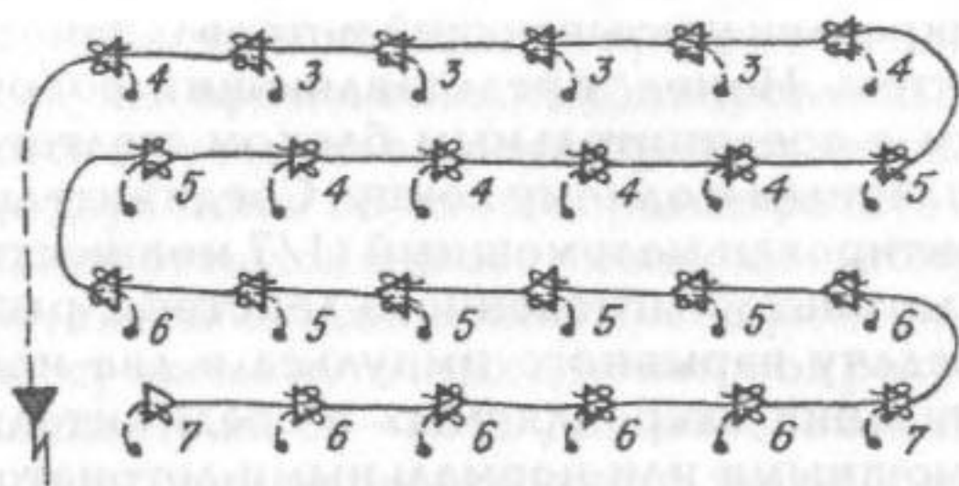
Рис. 2.11. Схема монтажа сети при порядном взрывании уступов: 3, 4, 5, 6, 7 — ступени замедлений
