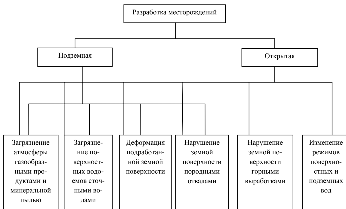
Рис. 12.1. Структурная схема изменений в окружающей среде при разработке полезных ископаемых
