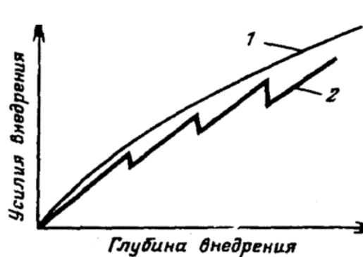
Рис. 1.2. График изменения усилий с увеличением глубины внедрения инструмента в породу при малых (1) и больших (2) скоростях
