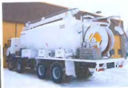
Универсальная СЗМ 20 т производства International Explosives Equipment (Австралия) в ОАО «Стойленский ГОК»
