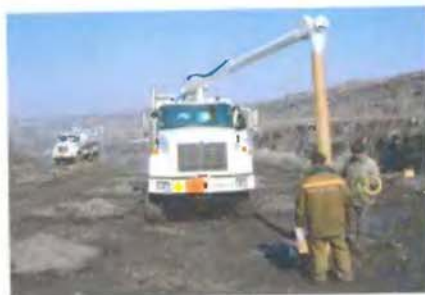
Заряжание тяжелого АНФО с помощью универсальной СЗМ 16 т производства Tradestar Corporation (США) на карьере ЗАО «Черинговер»
