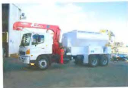
СЗМ для АНФО 8 т производства International Explosives Equipment (Австралия) с манипулятором для загрузки АС
