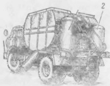
Рис. 15.11. Зарядная машина МЗ-8 с приставками ИПИ для приготовления иуданита: 1 и 2 — емкости соответственно для жидкого горючего и порошкообразной добавки
