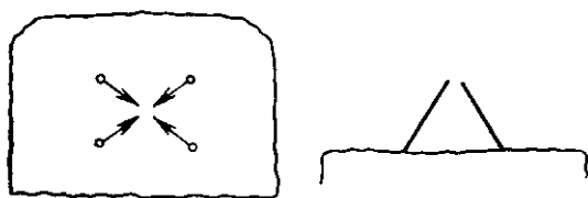
Рис. 4.6. Схема пирамидального вруба
