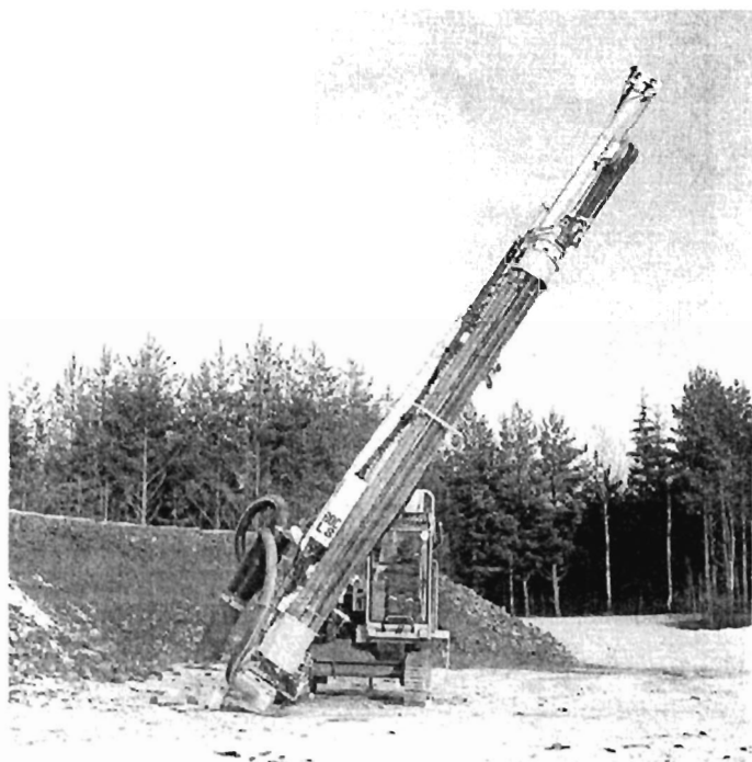
Рис. 3.3.10.9. Бурение скважин под углом
