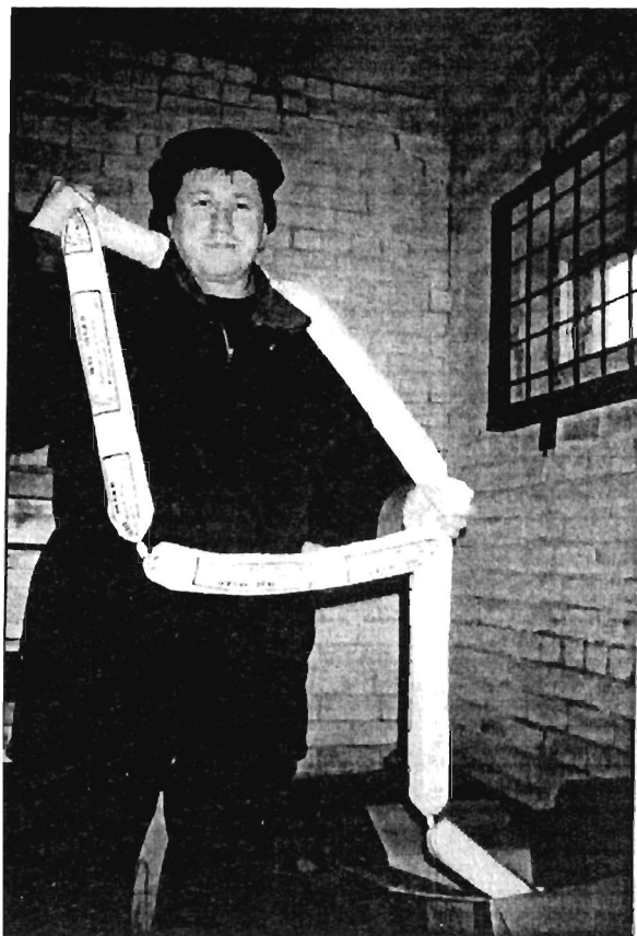
Рис.3.3.10.3. Общий вид зарядов ЗКВГ-60 отечественного производства
