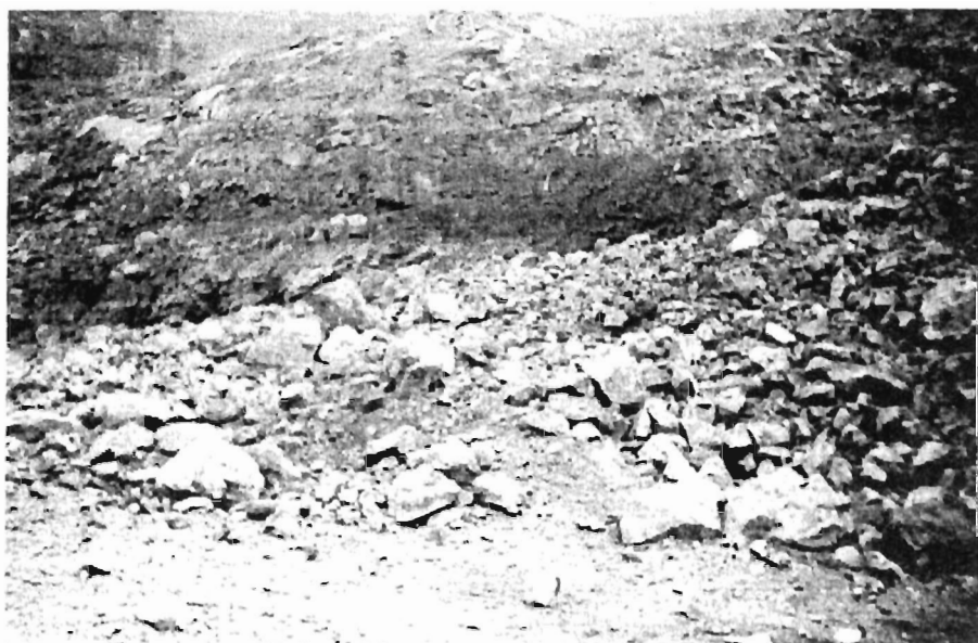
Рис. 5.1.15. Основной развал породы
