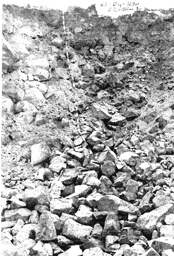
Рис.5.3.4. Контрольный участок после взрыва (верх уступа)
