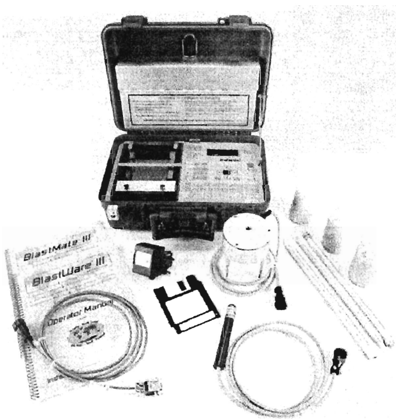
Рис.4.1.1. Сейсмограф "BlastMate III"
