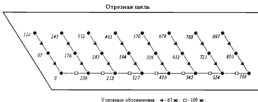
Рис.3.3.6.3. Схема взрывания при трех рядах отбойных скважин (с применением отбойных зарядов традиционной конструкции)
