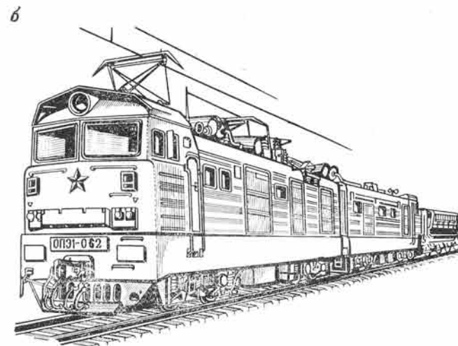
Рис. 2.26. Электровозы управления с кузовами будочного типа (ПЭ2М) (а) и вагонного типа (ОПЭ1) (б)
