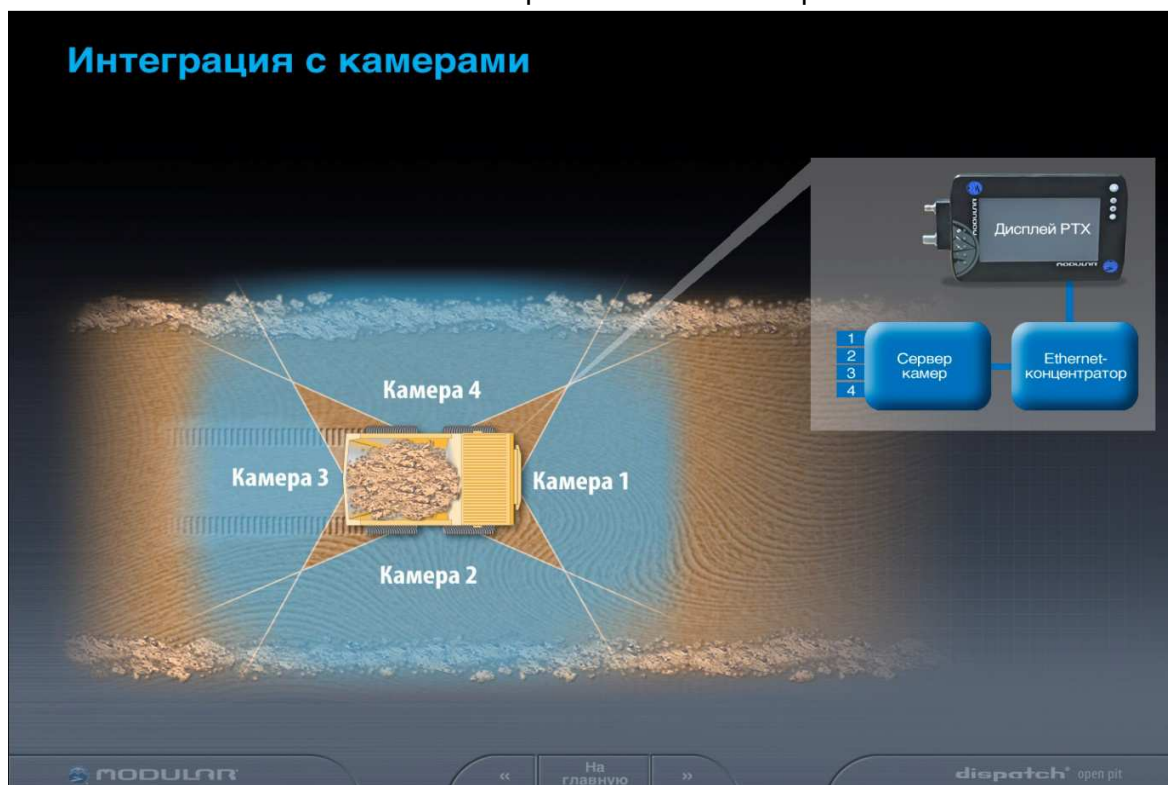
Рис. 54 –Пример оснащения автосамосвала камерами
