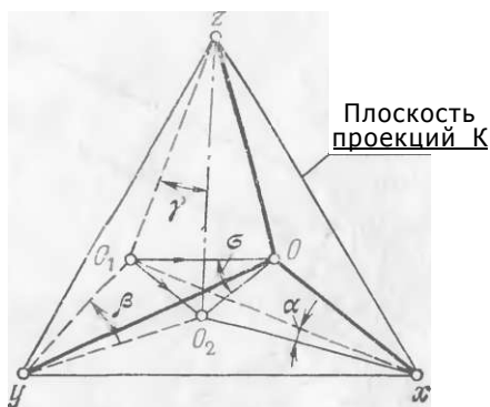
Рис/1.5. Условные пространственные прямоугольные и аксонометрические координаты
