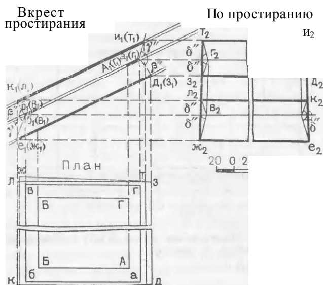
Рис. XIII.3. Построение предохранительных целиков в пластах под и над затопленными выработками:
