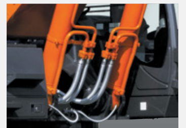
Защита шлангов гидроцилиндров стрелы
