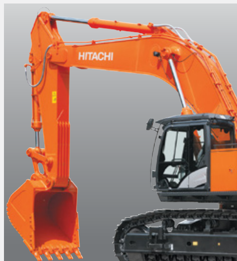
Усиленные стрела и рукоять со скальным ковшом (ZX670LCH-56)
