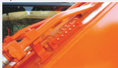
Точки централизованного смазывания шарниров стрелы и рукоятки
