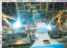
Линия сварки основной рамы
