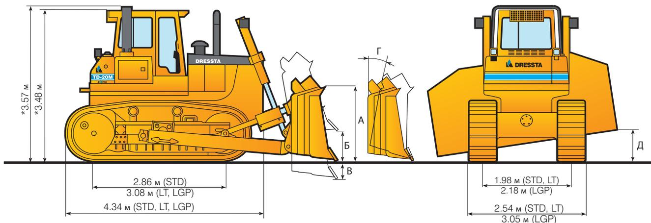
\*РАЗМЕРЫ ВКЛЮЧАЮТ ВЫСОТУ ГРУНТОЗАЦЕПА 67 мм.
