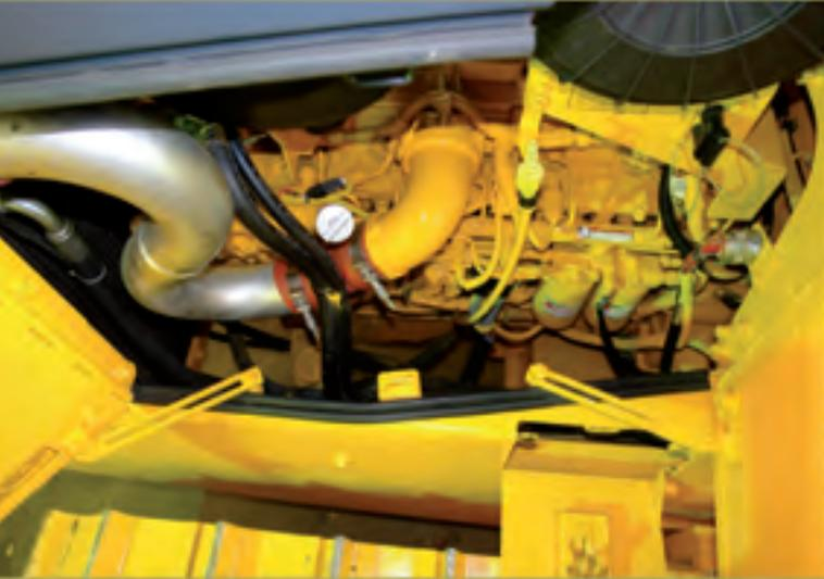
Двигатель Cummins QSC8.3 соответствует требованиям стандартов «EU Stage IIIA» и «EPA Tier 3» по токсичности выпускных газов. Прогрессивная электронная система QSC обеспечивает повышение технических характеристик двигателя, повышает крутящий момент и улучшает приемистость двигателя на любой скорости вращения. Большая периодичность технического обслуживания, отличный запуск машины в условиях холодного климата и низкий уровень шума при работе значительно повышают комфортность работы оператора.
