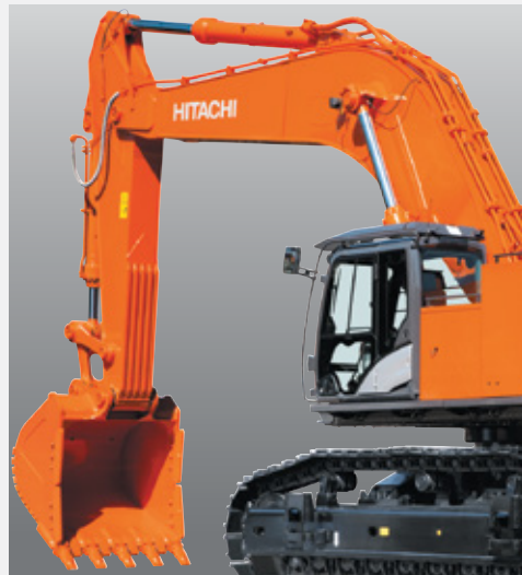
Усиленные стрела и рукоять со скальным ковшом (ZX870H-66 / ZX870LCN-66)
