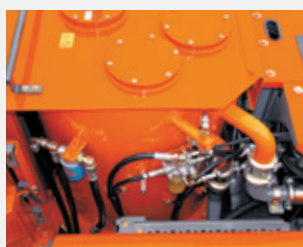
Фильтры на стенке центрального прохода
