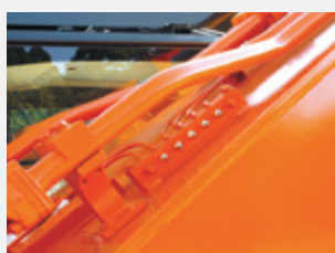
Точки централизованного смазывания шарниров стрелы и рукояти
