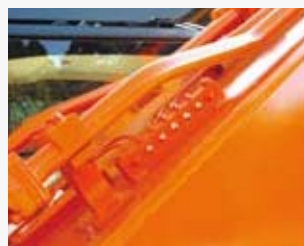
Централизованные точки смазки узлов стрелы и рукояти
