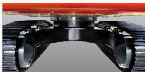
Ходовая часть с неизменяемой колеей
