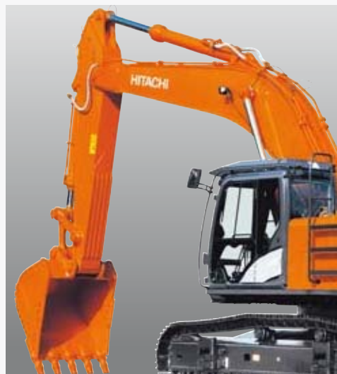
Усиление конструкции стрелы и рукояти при установке скального ковша
