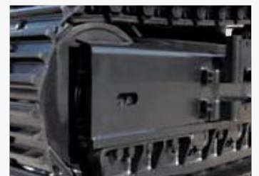
Кронштейн направляющего колеса
