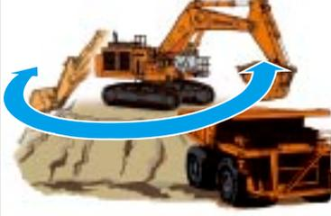
В этом режиме возрастает скорость поворота платформы, что позволяет снизить продолжительность рабочего цикла, включающего набор грунта, поворот платформы и выгрузку, в условиях, когда угол поворота платформы велик.
