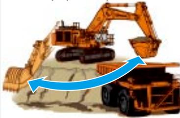
В этом режиме возрастает скорость подъема стрелы, что позволяет снизить продолжительность рабочего цикла, включающего набор грунта, поворот платформы и выгрузку, в условиях, когда угол поворота платформы мал.
